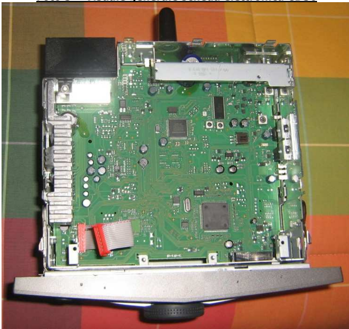
Foto 6 – Visuale del distacco frontale dalla radio
