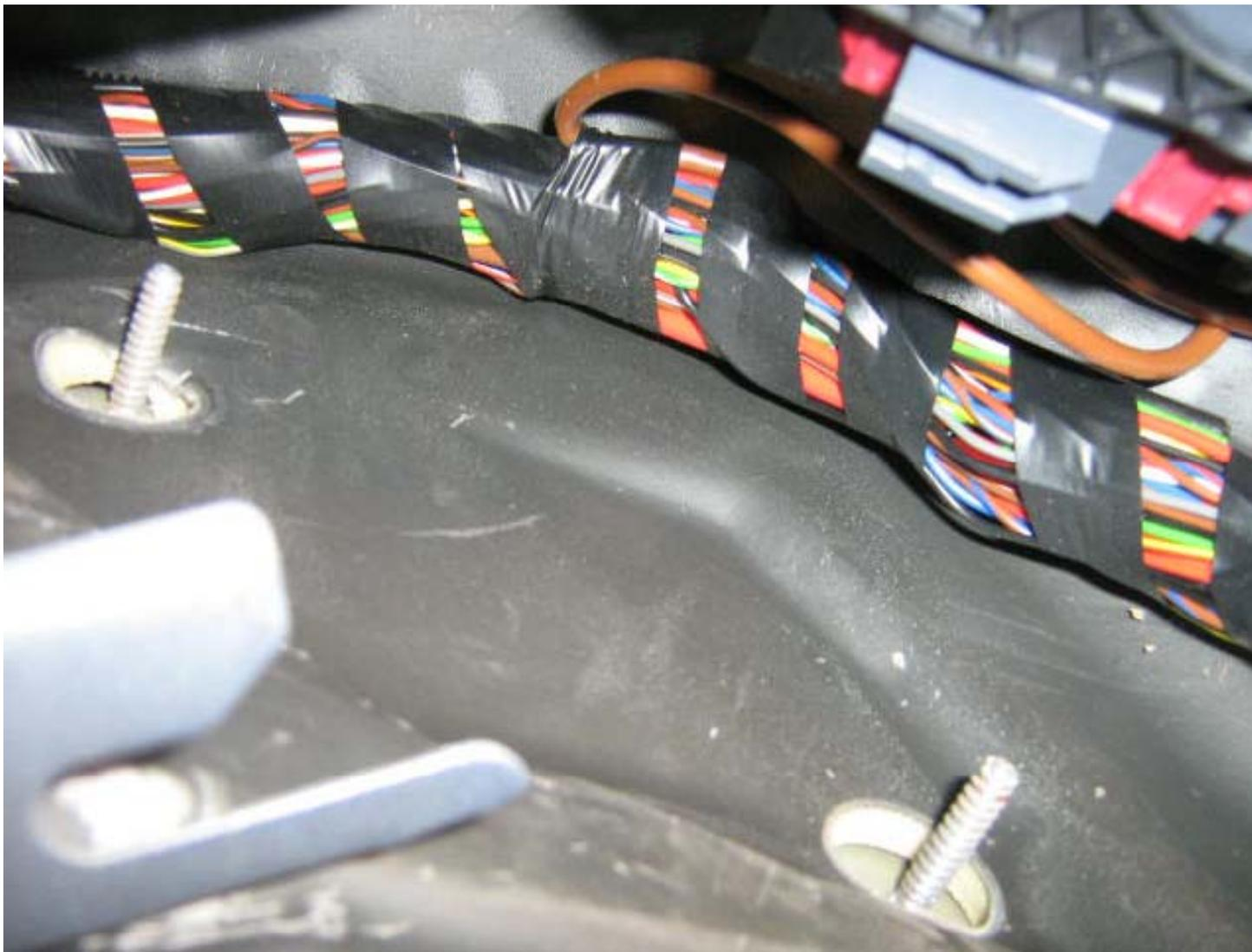
Connettore fissato al telaio della macchina. Si nota il cavo di massa connesso al telaio della vettura (cavo nero morsettato vicino ai due marroni).
