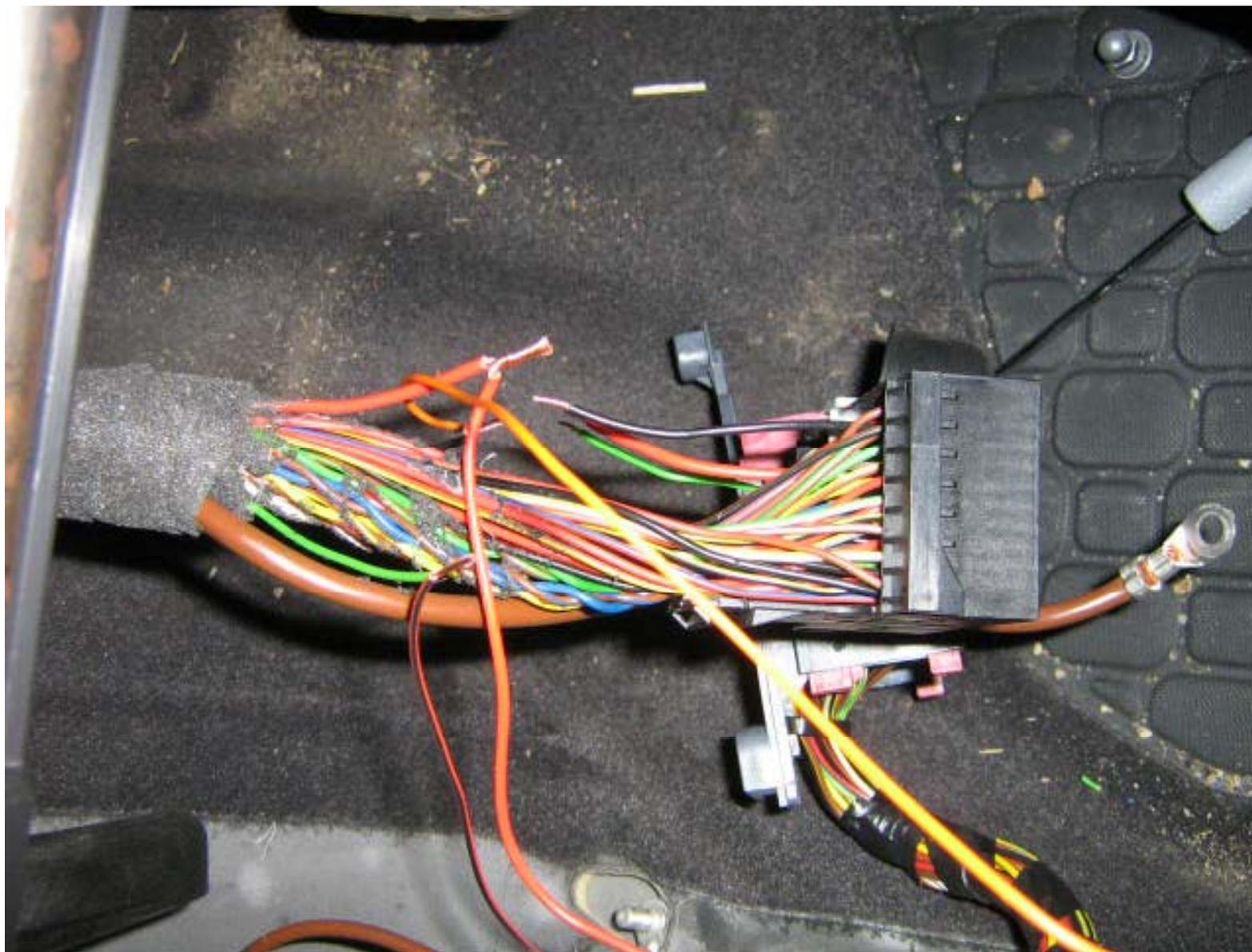
Altra foto del connettore. La parte proveniente dal motore è quella nera. La parte grigia, in basso è destinata ad alimentare e a portare i segnali per il retro della vettura.
