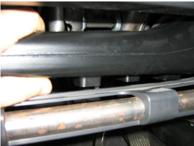
Finalmente ecco i motori: si noti la worm shaft del regolatore flussi, e il motore delphi in basso per la regolazione della miscelazione aria. Entrambi sono servomotori...motore + potenziometro per il posizionamento relativo.
