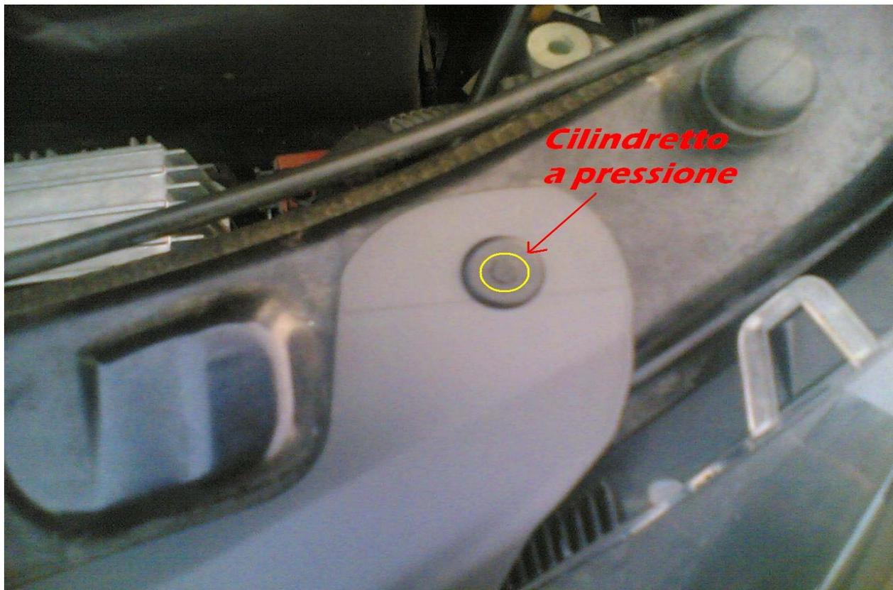
a questo punto dopo aver rimosso i cilindretti di ogni fermo rimuoviamo i fermi e stiamo attenti e non perdere niente che dovremmo rimontali al suo posto. Alziamo la calandra dall'alto per sbloccarla dai 6 fermi ad incastro nel paraurti in basso tirando in alto con molta cura. [Dettaglio fermi:](#)
