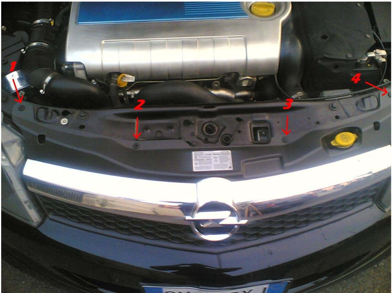
Bisogna premere al centro di ogni fermo e vedrete fuoriuscire sotto un piccolo cilindretto di plastica che farà allargare il fermo in modo da essere rimosso con facilità. [Ecco un dettaglio per capire meglio:](#)
